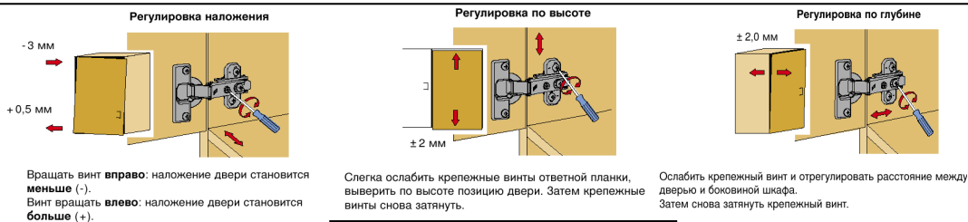
Рис. 3 Схема установки петель
