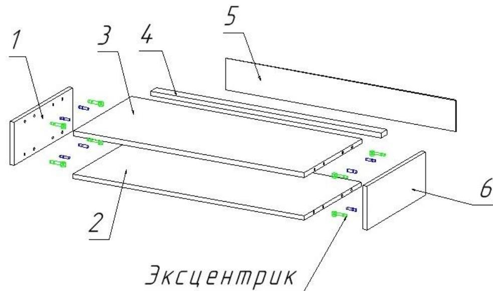
*Схема сборки ящика со скрытыми направляющими*
