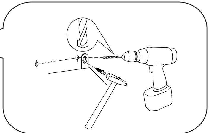
Для избежания повреждения газовых, вентиляционных водопроводных и электрических коммуникаций, обратите внимание на их расположение!
